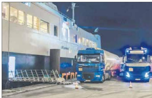
weniger CO2 ausgestoßen. Des Weiteren reduziert das Liquefied Natural Gas Feinstaub nahezu vollständig und Schwefeldioxid entsteht gar nicht erst. Gerade vor wenigen Tagen wurde die GREENFERRY I in Cuxhaven am Steubenhöft durch die Unternehmen LIQUID Marine und GasCom zum 100. Mal per LKW mit LNG versorgt. Bereits seit März dieses Jahres wird der Kraftstoff durch die professionellen Zulieferer effizient und sicher bebunkert. Aktuell wird das LNG im arabi-
